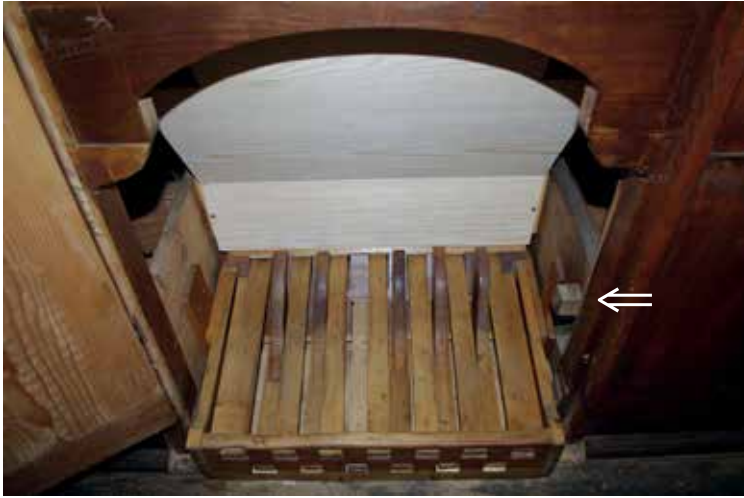
Pedalone con incastro Pedal mit einrastbarem Fusstritt
