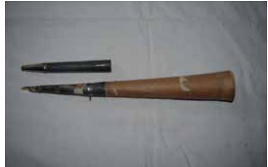
Canna del registro Tromba aperta Pfeife des Registers Tromba (Trompete), geöffnet
