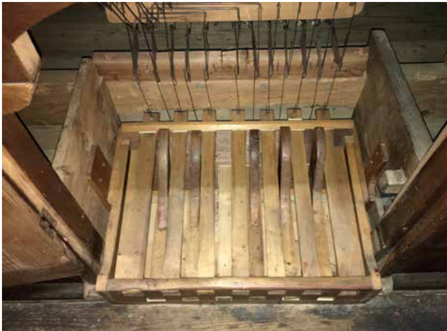
Pedali “leggio” Schräggestelltes Pedal
