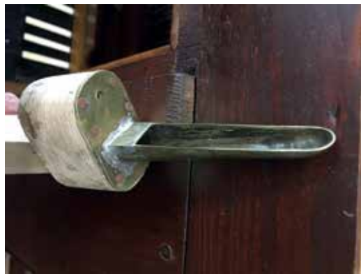
Canaletto in ottone appartenente al Trombone Kehle der Trombone (Posaune) aus Messing
