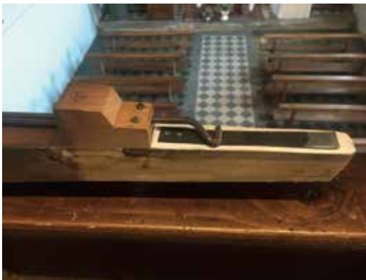
Canaletto in legno appartenente al Trombone Kehle der Trombone (Posaune)
