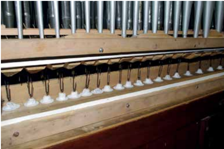
Interno della segreta del somiere maestro Einblick in die Windkammer der Hauptwindlade
