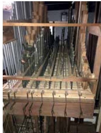
Canne restaurate Restaurierte Pfeifen im Pfeifenraster auf der Windlade
