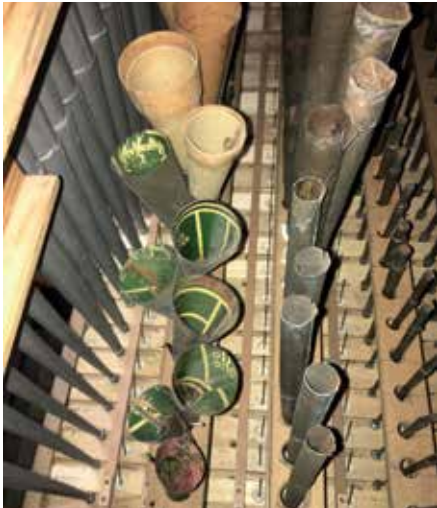
Risuonati della Tromba ottenuti da latte, resti delle etichette Olio Sasso Schallbecher der Tromba (Trompete) aus Blech, Reste der Etiketten Olio Sasso
